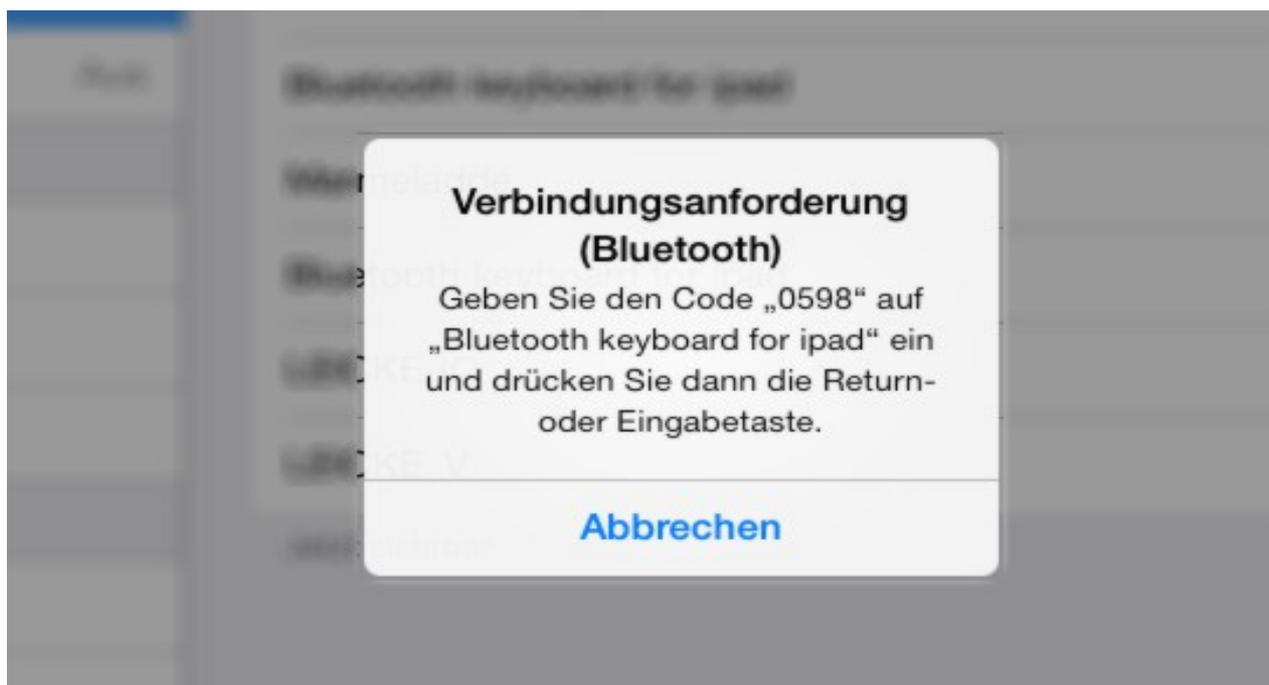
**Schritt 6:** Sie haben die Tastatur erfolgreich mit Ihrem Tablet verbunden. Die Verbindungsdaten bleiben auch bei ausgeschalteter Tastatur erhalten. Sollten Sie nun aus Versehen bei verbundener Tastatur an den Connect-Button kommen, kann eine Fehlermeldung erscheinen. In diesem Fall schalten Sie die Tastatur einfach kurz aus und wieder an.
