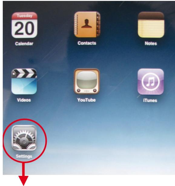
**Étape 4:** Choisissez sur votre menu système "Paramètres" pour obtenir les paramètres Bluetooth. Cliquez sur "Bluetooth" pour établir la connexion. Le Nouvel iPad recherche automatiquement un appareil Bluetooth compatible.
